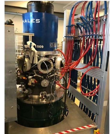
**1 MW, 170 GHz gyrotron**
